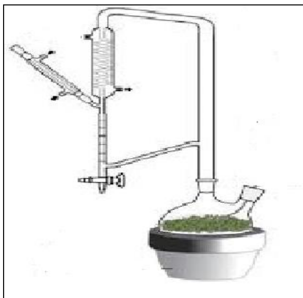
Figura 3. Esquema do aparelho Clevenger para extração (Fonte: Núcleo de Pesquisa de Plantas Medicinais, 2011).
