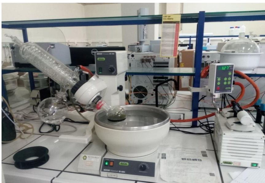
Figura 8. Evaporador rotativo, (Buchi), utilizado na preparação de extratos.
