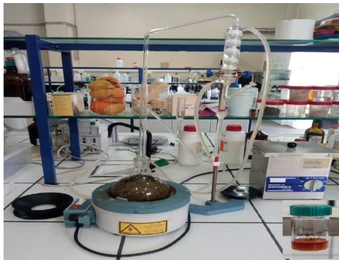
Figura 7. Aparelho de Clevenger para a realização da hidrodestilação e uma amostra de óleo essencial extraído de Segurelha seca guardado num frasco de vidro.
