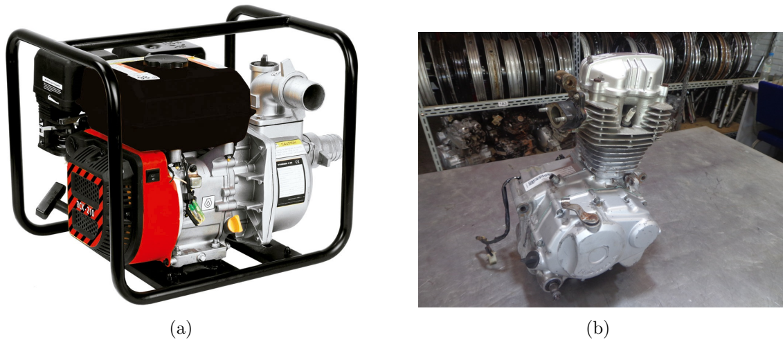
Figura 3.3: Equipamentos a serem abastecidos pelo gaseificador: a) Motobomba Campeon MRX-50, b) Motor de uma CG-125 Titan.
