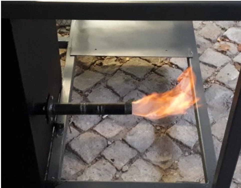
Figura 4.10: Queima do syngas produzido no gaseificador.
