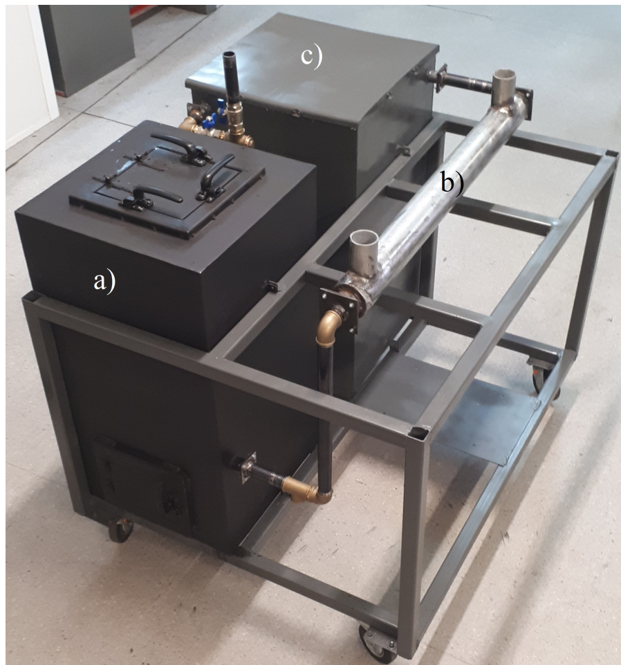
Figura 4.7: Protótipo do sistema de gaseificação para abastecer com syngas o motor da moto-bomba Campeon MRX-50: a) gaseificador; b) permutador a água; c) filtro.
