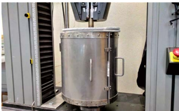
Figura 1: Forno fixado na base do Sistema de ensaios mecânicos da série Instron® 4485.
