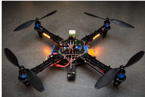
Figura 2.3: Exemplo de um quadcoptero, o tipo mais comum de VANTs de múltiplos rotores [22]
