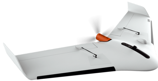
Figura 2.4: Exemplo de um VANT de asa fixa [4]
