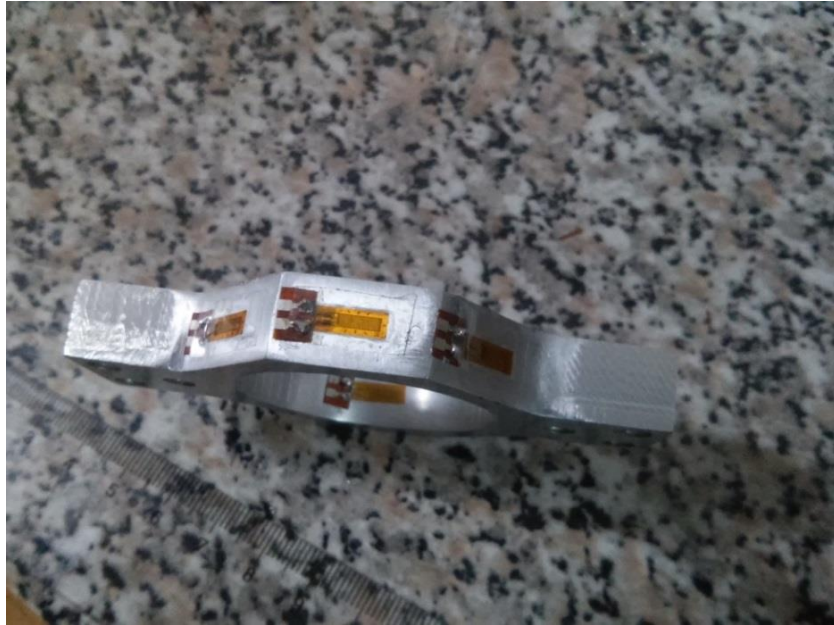
Figura 3-27. Vista da célula após colagem dos extensómetros.
