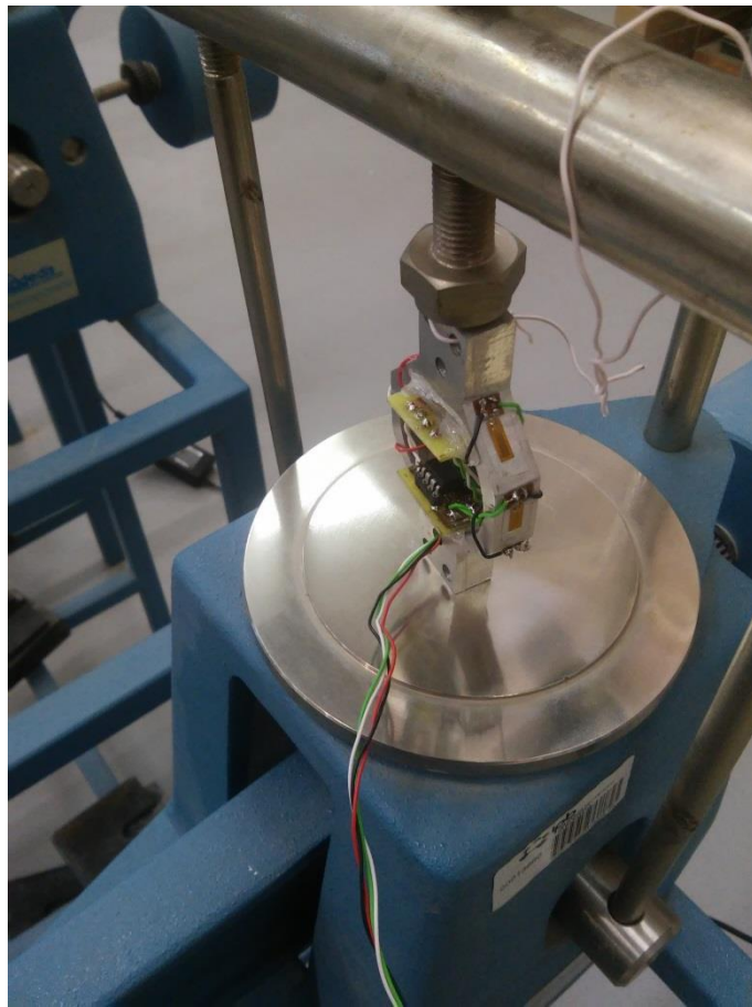
Figura 3-35. Calibração da célula.
