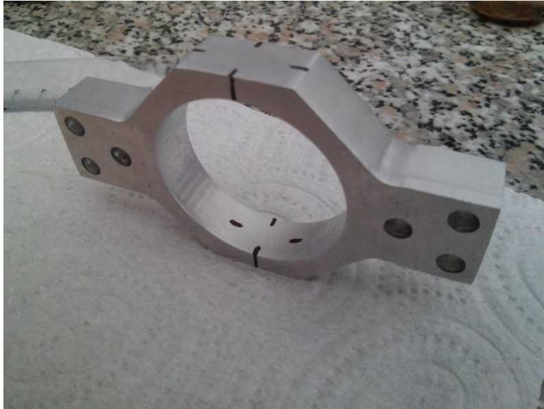
Figura 3-26. Marcas de referência na célula.
