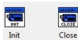
Figura 3-13. Blocos da LIFA para comunicação com Arduino.
