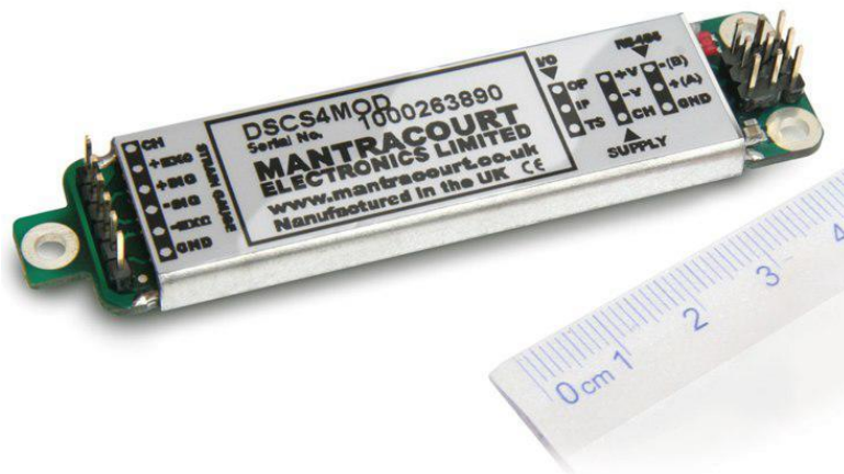
Figura 1-1. Digital Load Cell Converter. Direitos reservados à Mantracourt.
