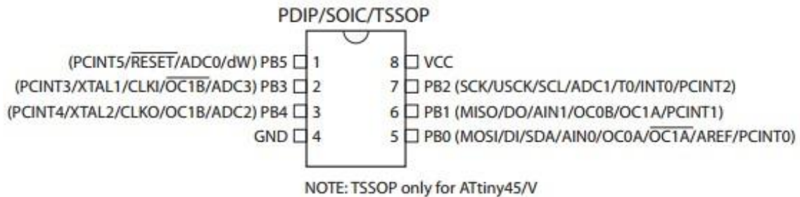
Figura 3-2. Pinos da gama ATTiny. Direitos reservados à Atmel Corporation.
