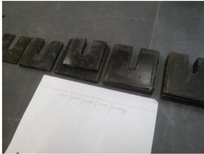
Figura 3-36. Pesos usados na calibração da célula.
