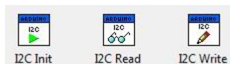
Figura 3-14. Blocos da LIFA para comunicação IIC.
