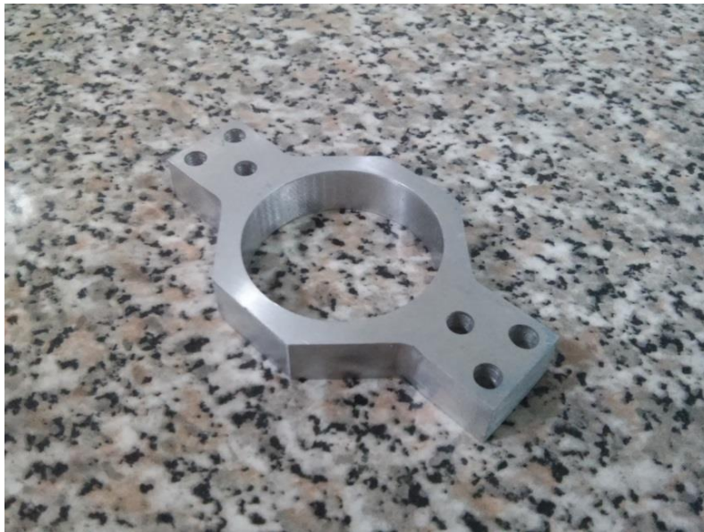
Figura 3-25. Elemento metálico da célula de carga.
