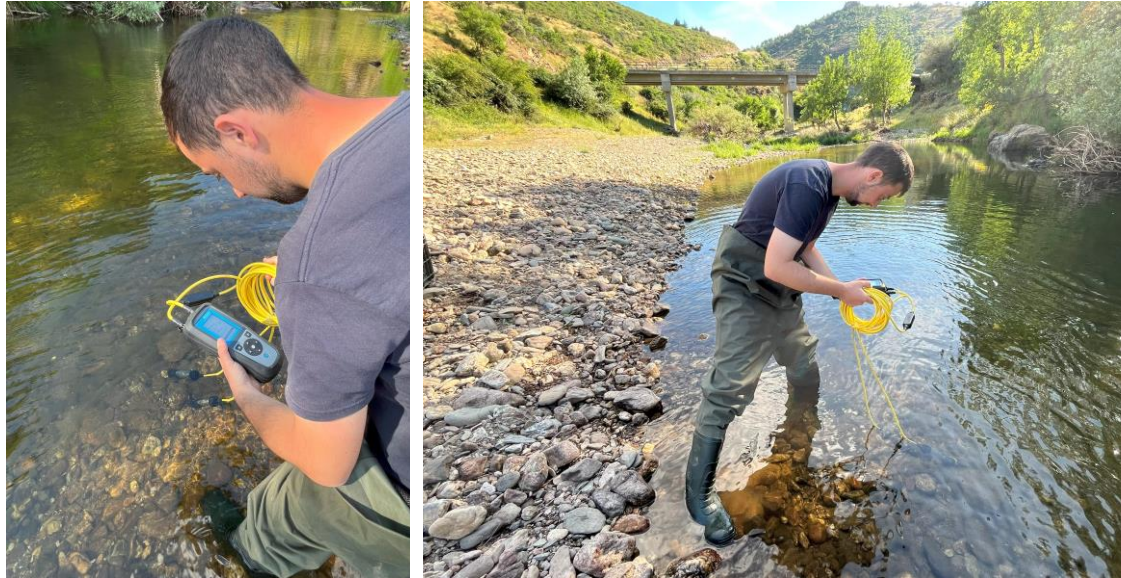
Figura 2.7. Medição in situ com sonda multiparamétrica de variáveis físico-químicas da água (primavera de 2023).
