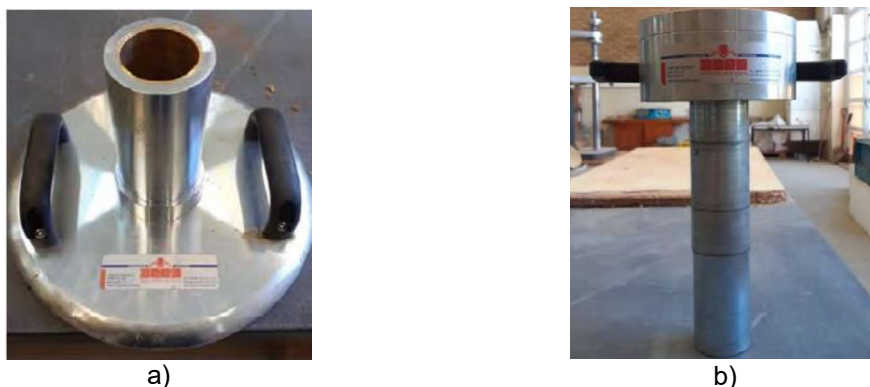
Figura 3 – a) Placa e b) Pistão do CBR Dinâmico (Wolf et al, 2021)
