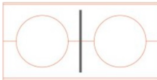
Figura 2.13: Reforço do montante da alma, [25].
