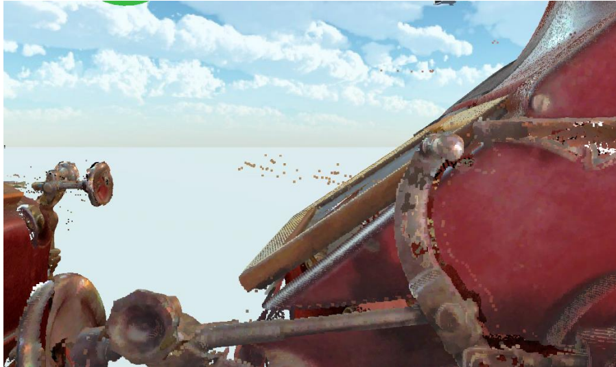
Figura 25 - Ruídos gerados na nuvem de pontos por superfícies reflexivas
