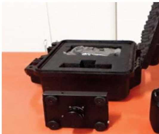
Figura 10 - Câmera multiespectral Tetracam, que possui bandas red, green e NIR.
