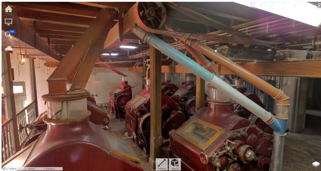
Figura 22 - Visualização 3D da sala capturada por fotos pelo scanner e demonstrada no software ReCap
