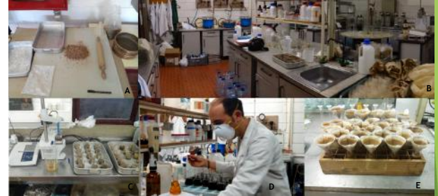
Crivagem (A); Análise laboratorial de parâmetros físico químicos (B); pH (C); Matéria orgânica (D); Fósforo e potássio (E); Azoto; Bases de troca, acidez de troca e capacidade de troca catiônica; Textura
