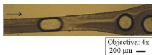
Figura 2. Imagem de um escoamento de microbolhas de ar ao longo de um microcanal [7].
