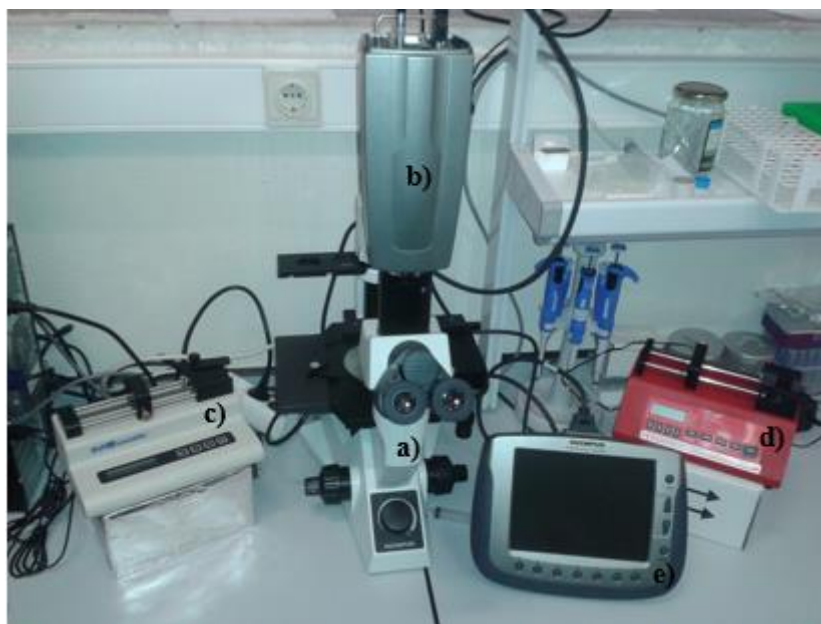
Figura 26. Visualização da instalação experimental, a) microscópio invertido Olympus IX71 , b) câmara de alta velocidade i- SPEED LT, c) bomba de seringa kdScientific , d) a bomba de seringa New Era , utilizadas para promover a entrada de sangue e ar, respetivamente, no microcanal, e) ecrã de visualização.
