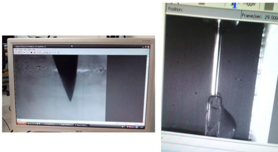
Figura 37. Visualização da posição da agulha em ambas as câmaras CMOS e CCD.
