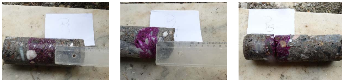
Figura 16 – Aspeto das carotes “in-situ” após pincelagem da superfície com fenolftaleína
