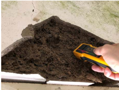
Figura 20 – (a) Medição qualitativa de humidade com humidímetro, (b) Destacamento de rebocos e betão
