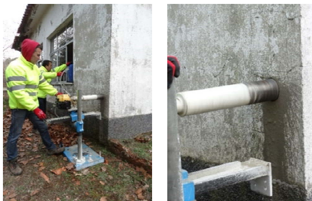
Figura 15 – Processo de extração de uma carote no pilar P 4
