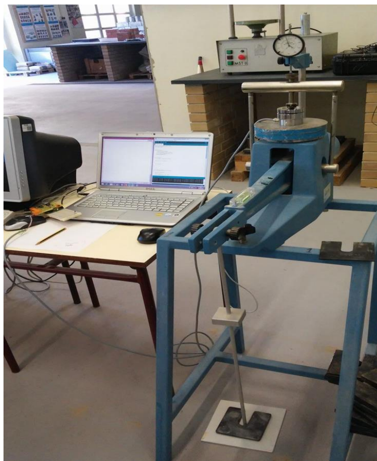
Figura 6-5 Calibração da célula de carga com prensa manual
