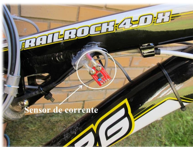
Figura 4-11 Sensor de corrente instalado
