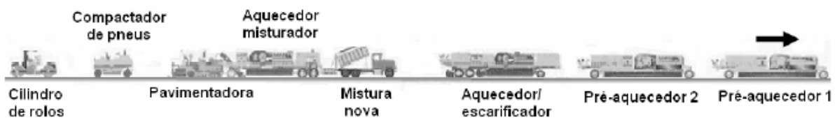
Figura 3.9 - Esquema do “comboio” de intervenção no processo de reciclagem "in situ" a quente com betume/rejuvenescedor (Martinho, 2005).
