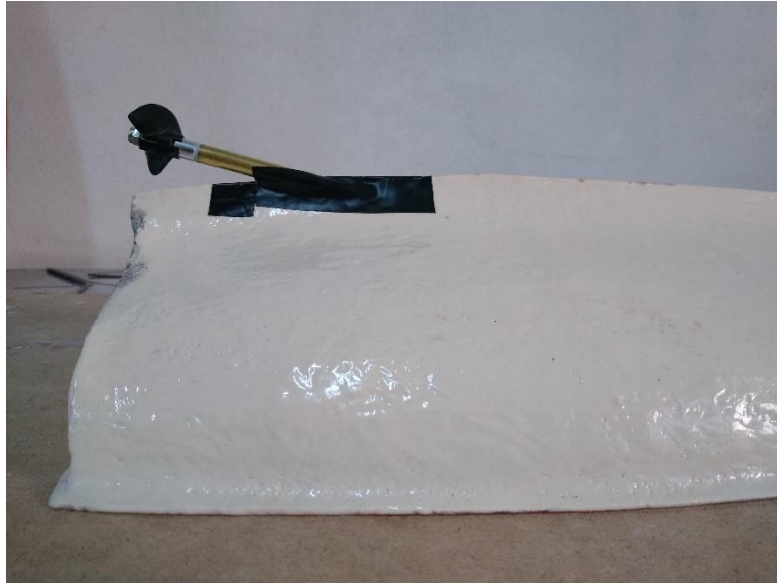
Figura 40 – Selagem externa para aplicação da resina poliéster na parte interior. Fonte: Autoria própria.
