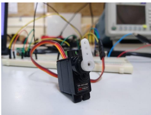
Figura 17 – Servomotor utilizado no trabalho. Fonte: Autoria própria.
