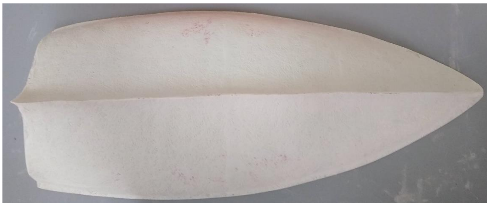
Figura 35 – Modelo após serragem e lixagem das bordas. Fonte: Autoria própria.
