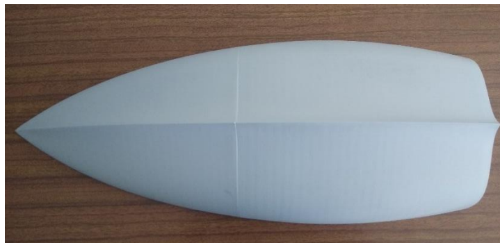
Figura 25 - Modelo após primeira camada de spray primário. Fonte: Autoria própria.
