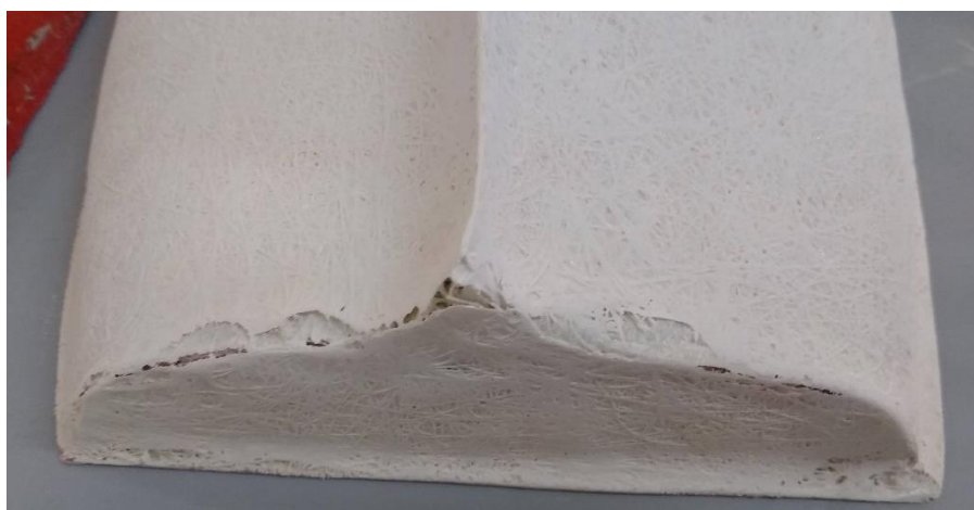
Figura 36 – Popa do casco com descontinuidades. Fonte: Autoria própria.
