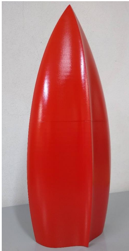
Figura 26 - Modelo após utilização do spray acrílico. Fonte: Autoria própria.
