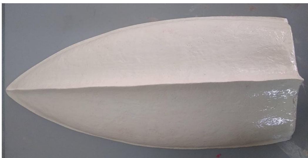
Figura 38 – Modelo após secagem da última aplicação de resina catalisada e pigmentada. Fonte: Autoria própria.
