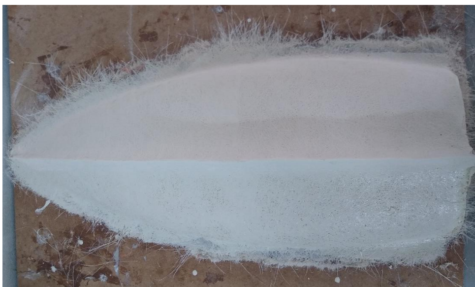
Figura 32 – Modelo após segunda 3ª e 4ª camadas de fibra de vidro. Fonte: Autoria própria.
