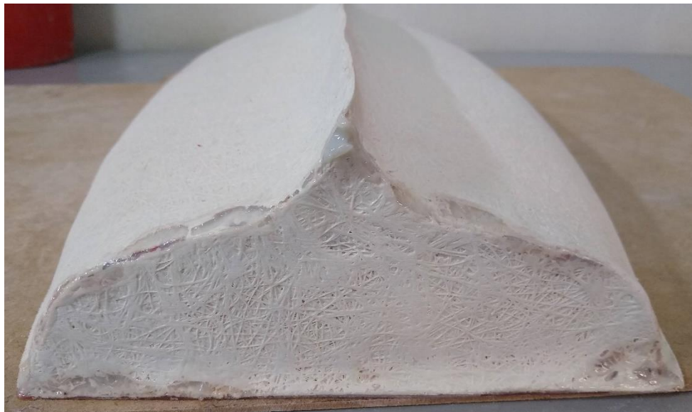
Figura 37 – Popa após aplicação da cola epóxi. Fonte: Autoria própria.
