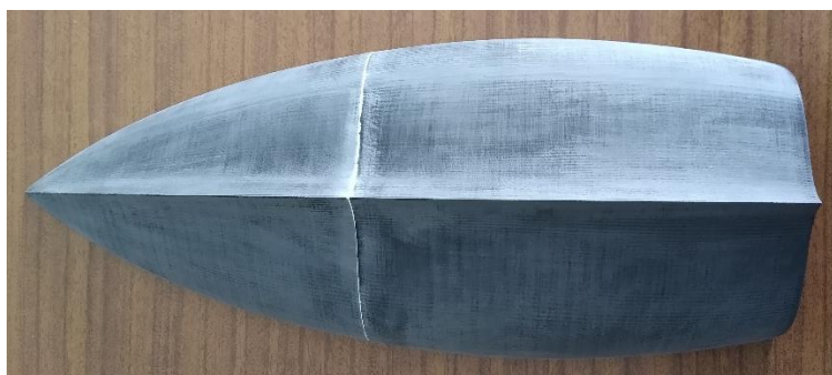
Figura 24 - Molde após primeira lixagem. Fonte: Autoria própria.
