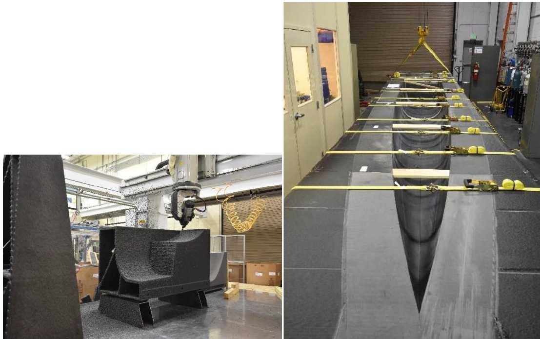
Figura 2 – Fabricação e montagem do molde em ABS reforçado com fibra de carbono. Fonte: Post et al., 2018.
