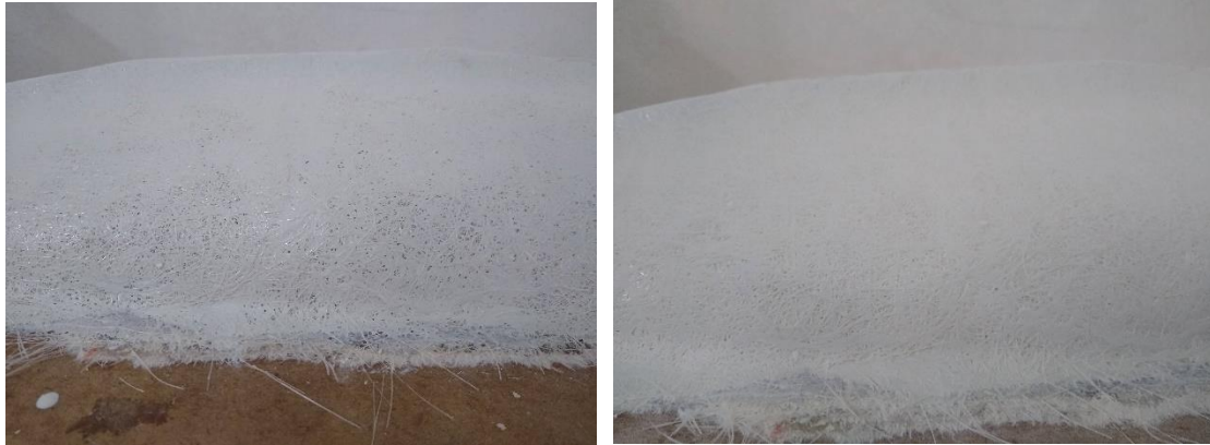
Figura 33 – Acabamento superficial à esquerda antes da lixagem e após a lixagem à direita. Fonte: Autoria própria.
