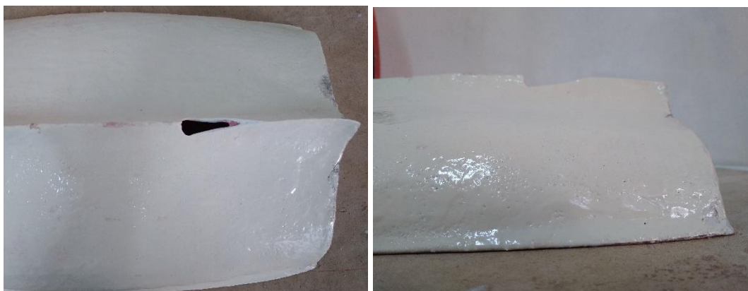
Figura 39 – Casco furado e lixado para fixação do eixo. Fonte: Autoria própria.
