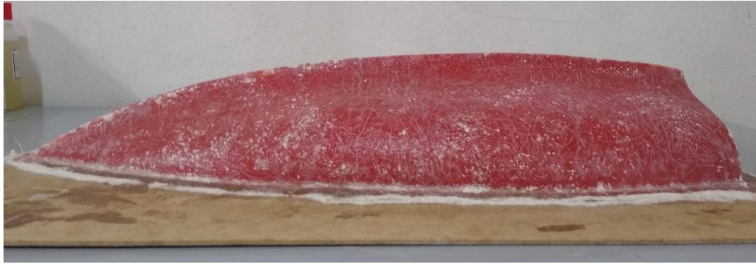
Figura 29 - Molde laminado com duas camadas de fibra de vidro. Fonte: Autorial própria.
