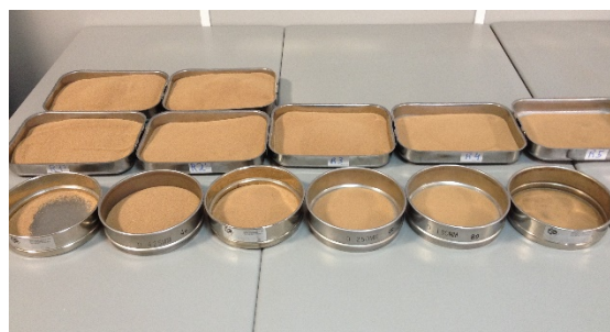
Fig. 1 – Peneiras utilizadas na composição granulométrica da cortiça.
