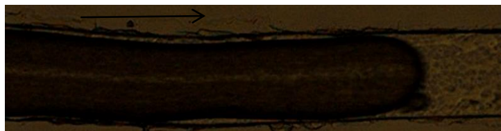
Figura 65 - Gota de Dex40_5%Hct sem células no centro, caudal de 1 \mu\text{l}\cdot\text{min}^{-1} para o óleo alimentar e de 5 \mu\text{l}\cdot\text{min}^{-1} para o Dex40_5%Hct.
