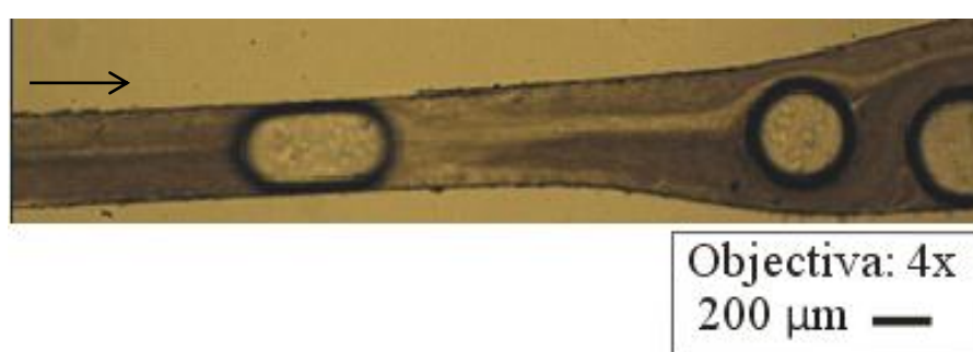
Figura 67 - Bolhas de ar no Microcanal 3 com caudal de 3 \mu\text{l}\cdot\text{min}^{-1} para o Dex40_10%Hct e de 30 mbar para o Ar.
