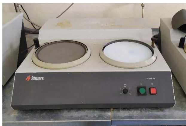
Figura 45 – Máquina de polimento Struers LaboPol-25.
