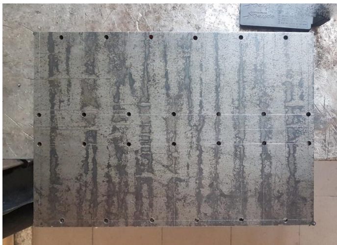
Figura 28 - Chapa de aço preparada para soldadura.
