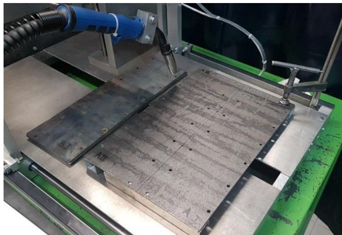
Figura 29 – Chapa de aço posicionada no aparato de soldadura.
