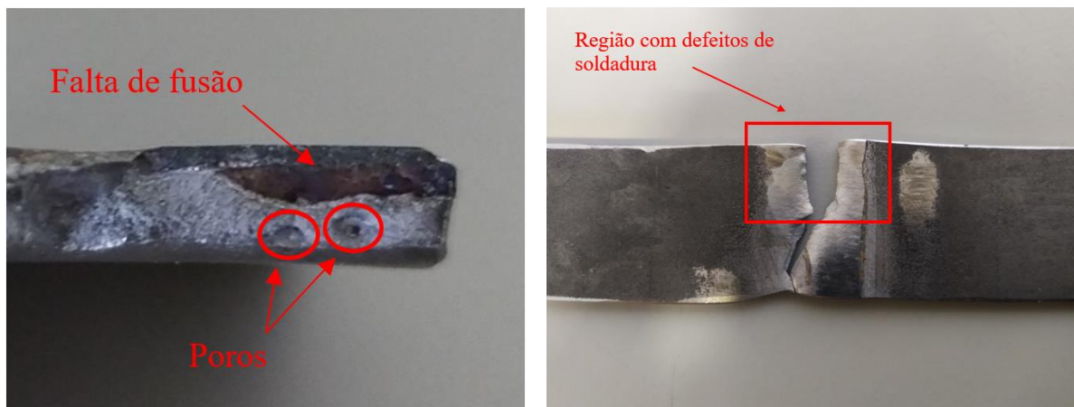
Figura 54 – Defeitos de soldadura no provete do ensaio de confirmação.
