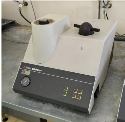
Figura 44 – Máquina de embutimento Struers LaboPress-1.
