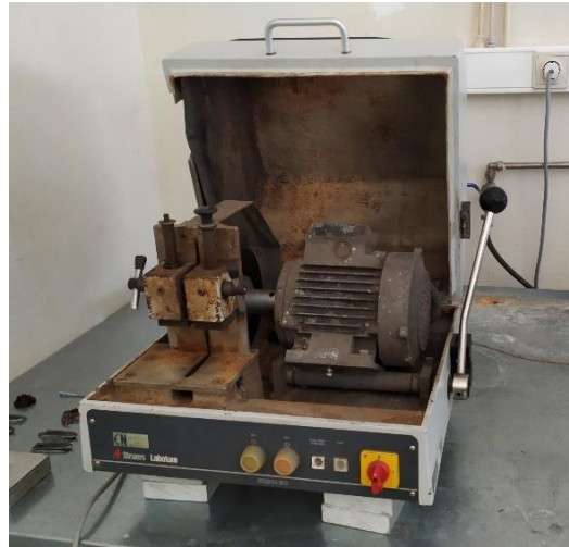
Figura 42 – Máquina de corte Struers Labotom.
