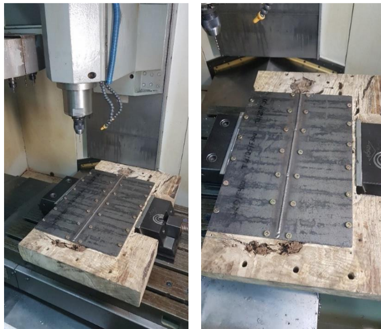
Figura 35 – Fixação das chapas de aço no centro de maquinagem CNC
