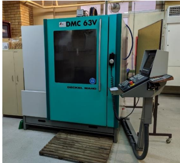
Figura 34 – Fresadora CNC para maquinagem das chapas.
