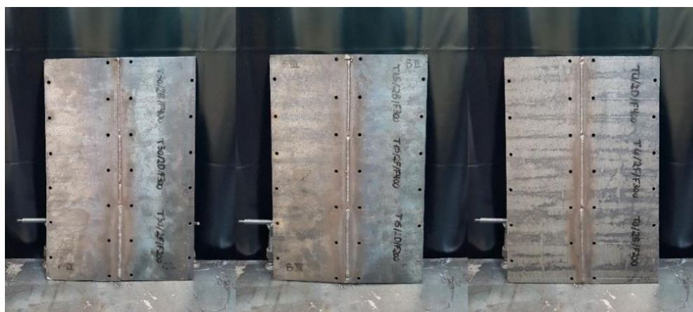
Figura 33 – Chapas soldadas com todas as combinações do experimento de Taguchi.
