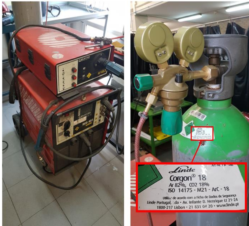
Figura 31 – Conjunto de soldadura fonte de energia e cilindro de gás.
