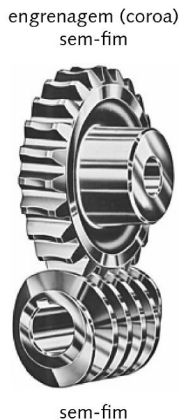
Figura 5 – Engrenamento simples, consistindo de um sem-fim e uma engrenagem sem-fim [4].
