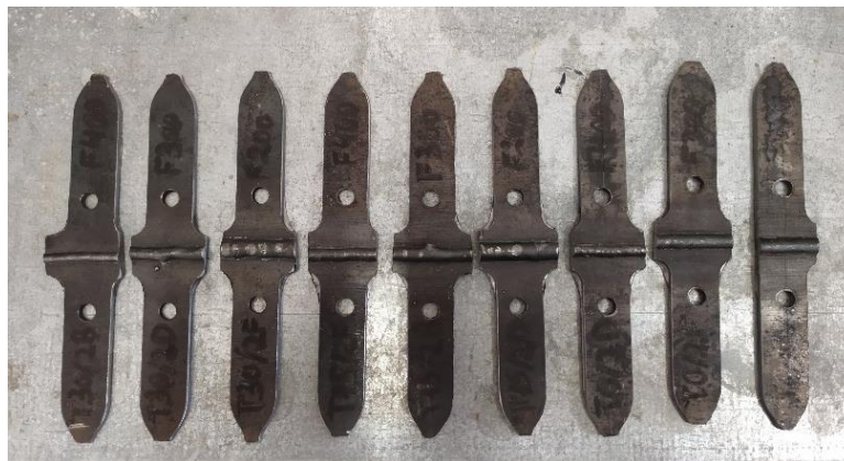
Figura 40 – Amostras de cordão de solda para macrografia.
