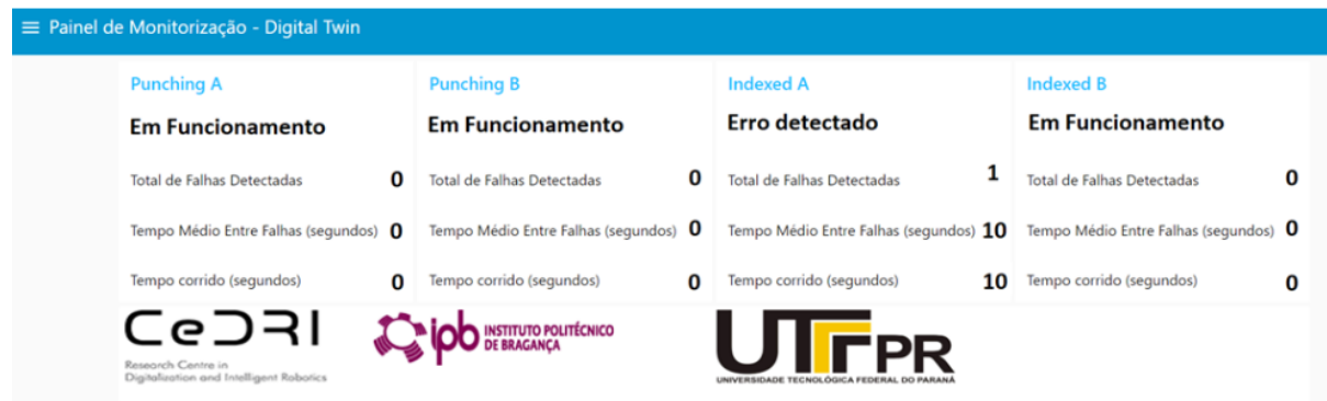
Figura 5.3: Painel de Monitorização do Digital Twin .
