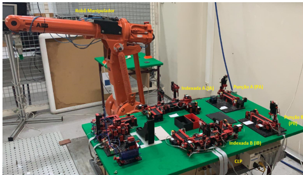
Figura 3.1: Sistema de manufatura flexível a ser virtualizado.
