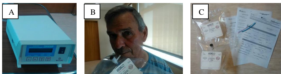
Figura 10. (A) Ammonia meter (B) Doente a exalar para o saco de tedlar (C) Saco de tedlar identificado.
