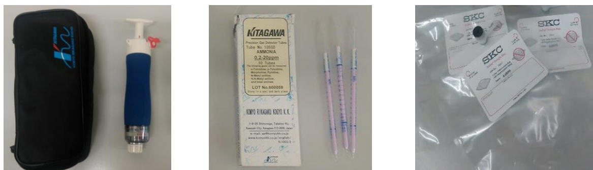
Figura 6. Materiais constituintes o dispositivo para análise colorimétrica.
