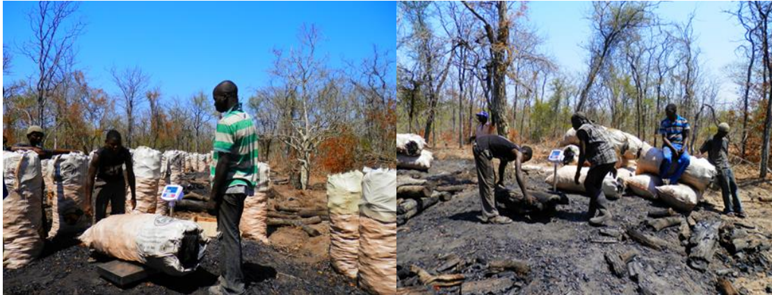
Figura 17: pesagem do carvão vegetal em cada forno (esq.) e madeira que não se transformou em carvão vegetal (dir.)
