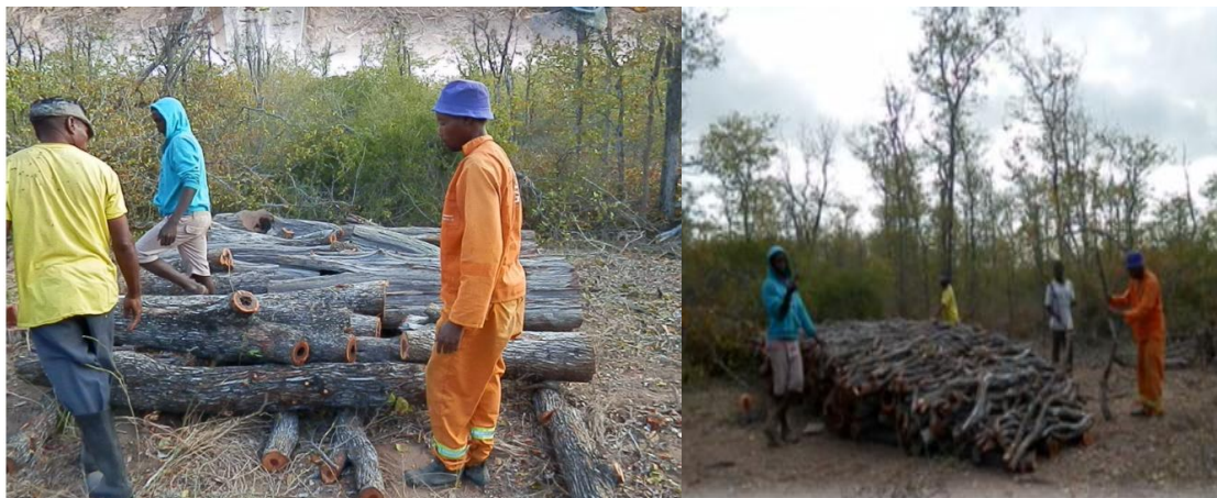
Figura 16: Preparação do forno de produção de carvão vegetal, base do forno ou cama (esq.) e madeira arrumada (dir.) (Fonte autora)
