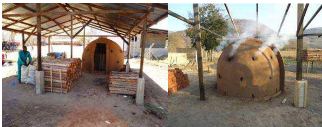
Figura 12: Fornos do tipo Rabo quente (Fonte Fernandes 2014)
