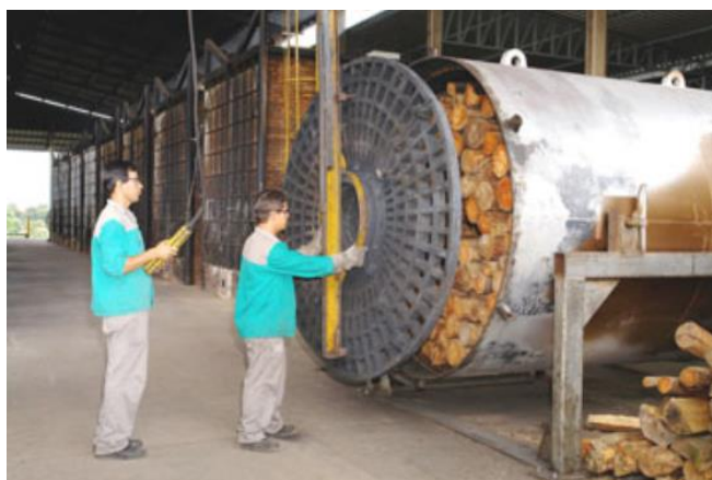
Figura 13: Forno container (Fonte Ameloti e Carvalho 2012)
