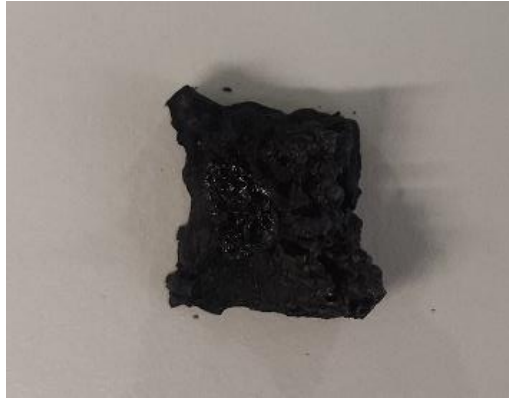
Figura 44: Amostra MDI após teste de compressão realizado.
