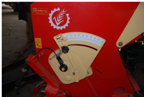
Figura 3. Caixa de velocidades na transmissão roda motora / órgãos de distribuição
