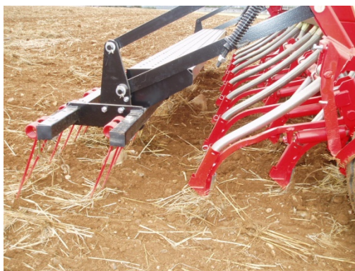
Figura 4. Tubos condutores e órgãos de enterramento
