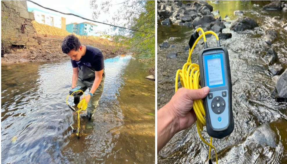
Figura 14: Medição de variáveis físico-químicas com sonda multiparamétrica.
