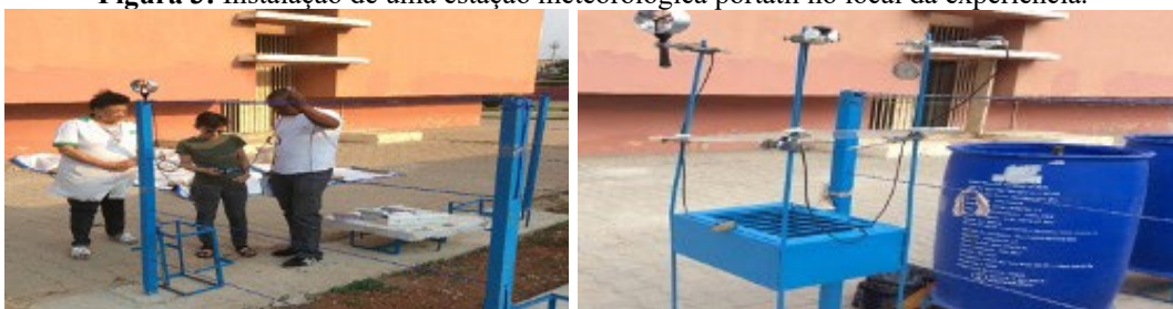
Figura 3: Instalação de uma estação meteorológica portátil no local da experiência.
