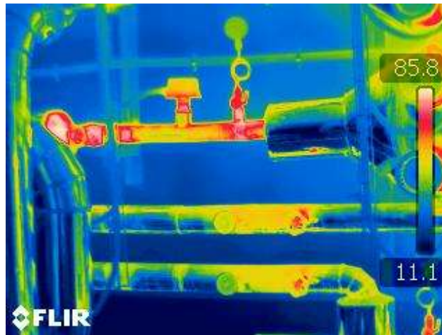
Figura 5-2-Perdas de energia associadas ao mau isolamento do circuito de aquecimento.
