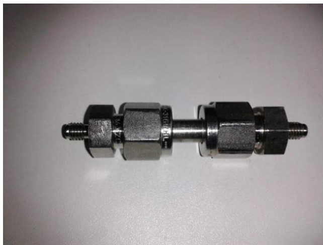
Figura 2.3: Coluna de aço inoxidável após a sua construção.
