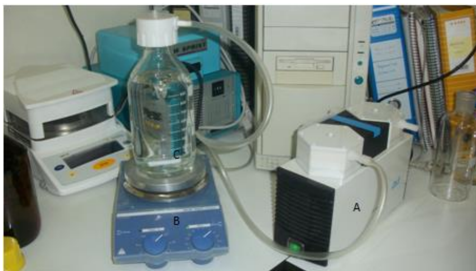
Figura 2.4: Kit de sucção. A) Bomba de vácuo. B) Placa de agitação. C) Íman magnético.
