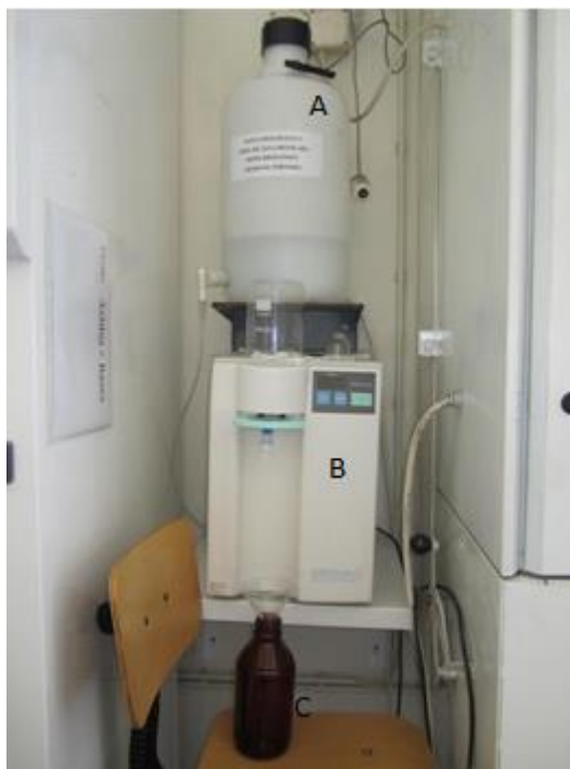
Figura 2.5: Representação do equipamento de desionização: A) Recipiente de água destilada; B) Barnstead EASYpure UV Compact Ultra Pure Water System ; C) Recipiente de armazenamento de água desionizada.
