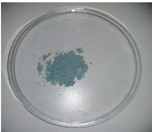
Figura 2.8: Representação visual do MOFs do tipo MIL-100, disponibilizado pelo laboratório de Lavoisier.
