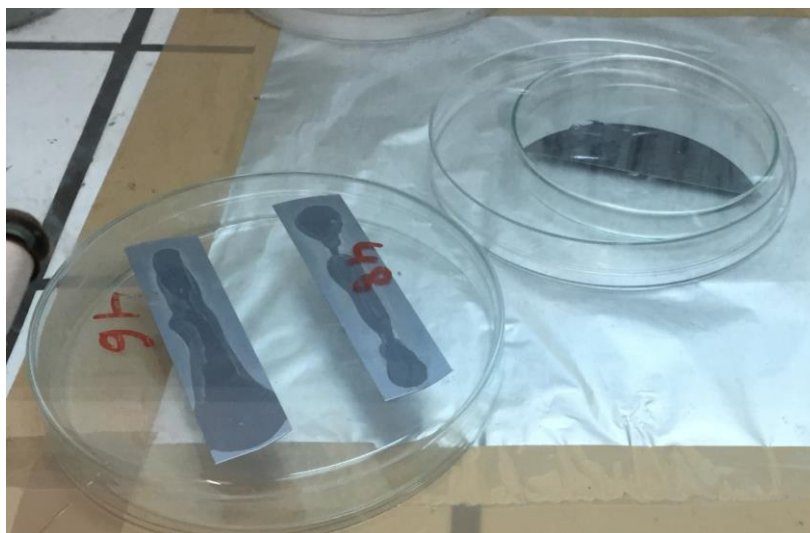
Figura 24 - Silanização dos microcanais.
