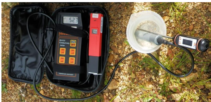
Figura 6: Determinação, in situ , da condutividade elétrica e temperatura da água.
