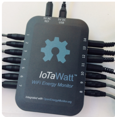
Figura 3.4: Exemplo de um equipamento IoTaWatt, semelhante ao utilizado no projeto.[30]
