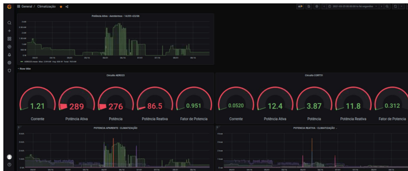
Figura 4.5: Interface para visualização dos dados elétricos coletados pelo IoTaWatt feita pelo software Grafana. Fonte: Autoria própria
