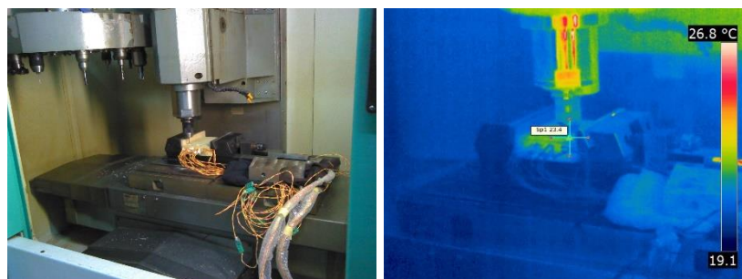
Figura 18: Furação no material T+D e imagem termográfica.
