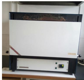
Figura 12 – Mufla utilizada para incineração das amostras Impacto da proveniência da abelha na qualidade da própolis
