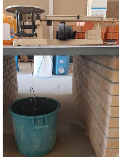
Figura 35 - Balança hidrostática utilizada no ensaio de absorção por imersão
