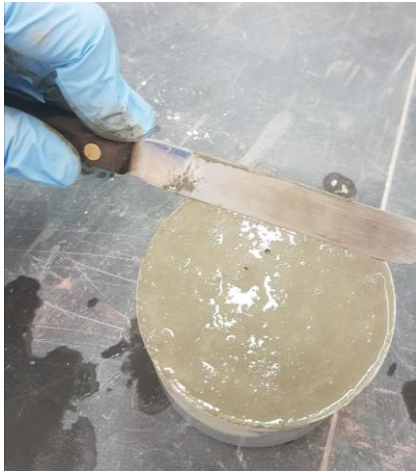
Figura 30 – Regularização do topo do recipiente para ensaio em estado fresco
