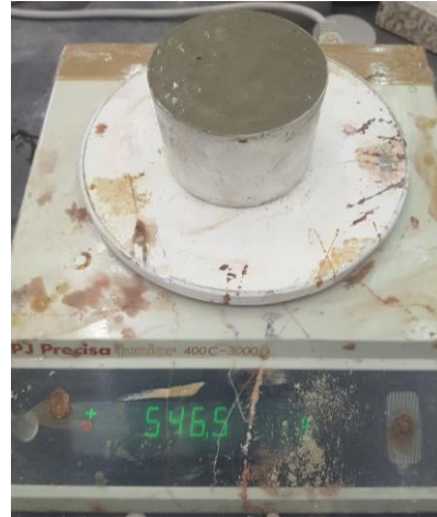
Figura 31 - Aferição do peso recipiente + concreto para o novo traço de CPR
