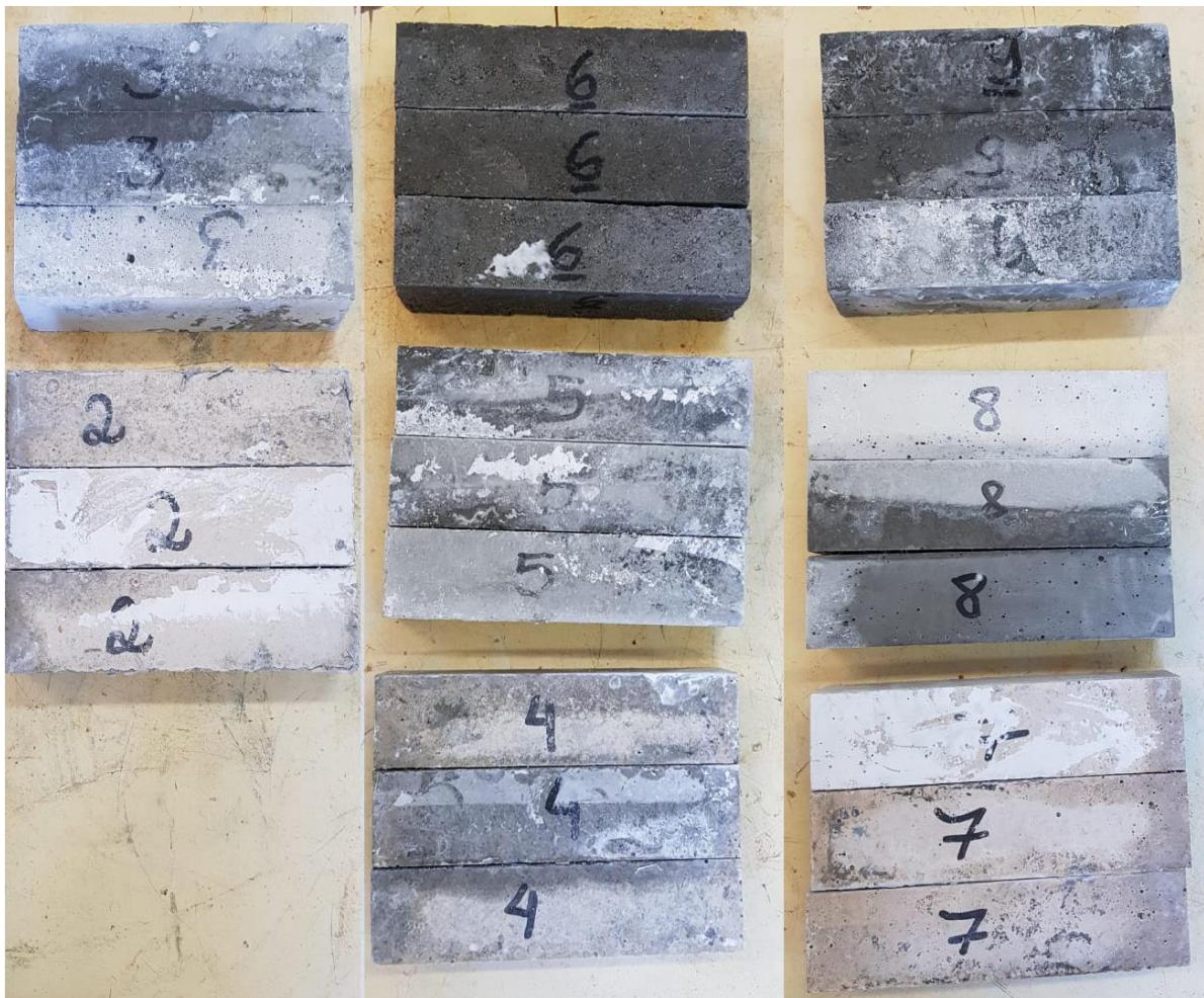
Figura 43 - Aspecto final dos provetes após cura térmica
