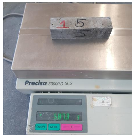
Figura 33 - Amostra para ensaio de absorção por imersão sendo pesado saturado
