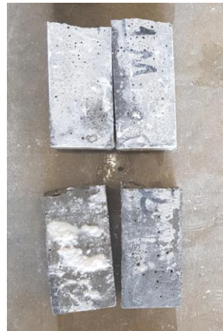
Figura 27 - Aspecto dos provetes após submetidos ao ensaio de resistência à flexão
