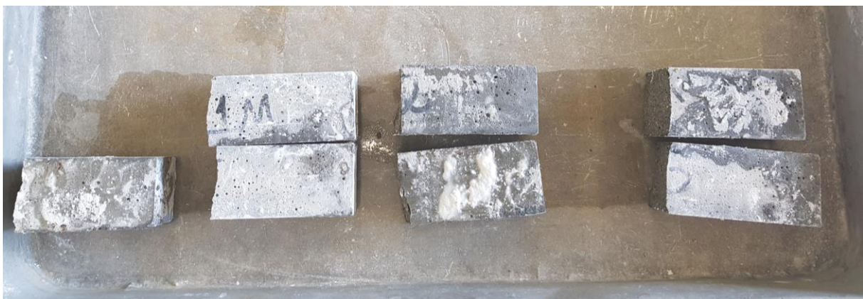
Figura 45 - Aspecto dos provetes aos 28 dias após ensaiados à flexão
