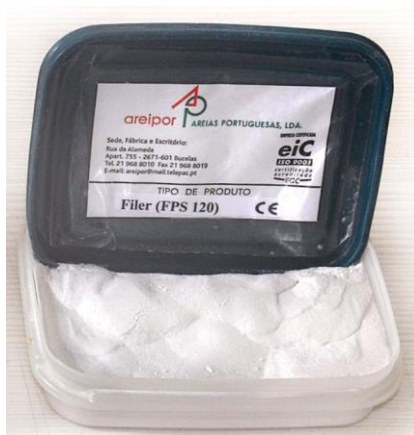
Figura 16 - Material usado como pó de quartzo no fabrico do CPR
