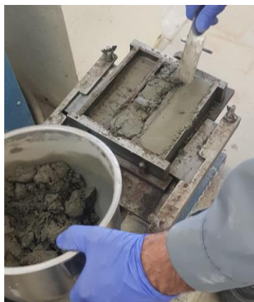
Figura 23 - Colocação da segunda camada para adensamento
