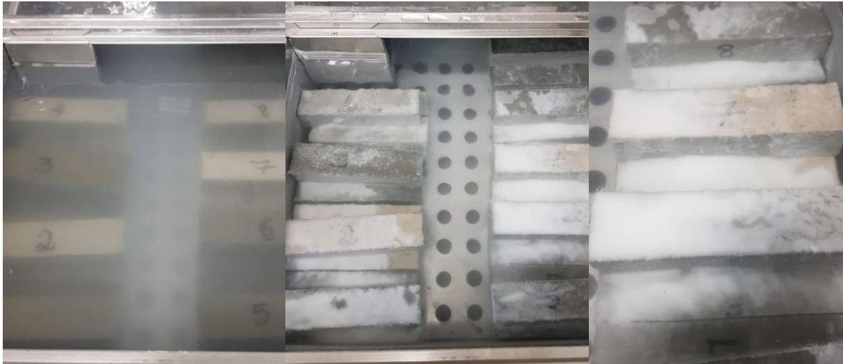
Figura 40 - Provetes passados 2 dias em cura térmica à 60°C
