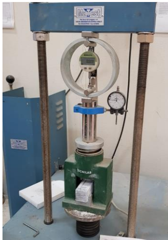
Figura 26 - Equipamento utilizado para ensaiar os provetes à flexão
