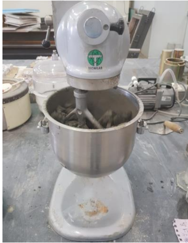
Figura 21 - Misturadora utilizada no processo de fabrico das misturas de CPR
