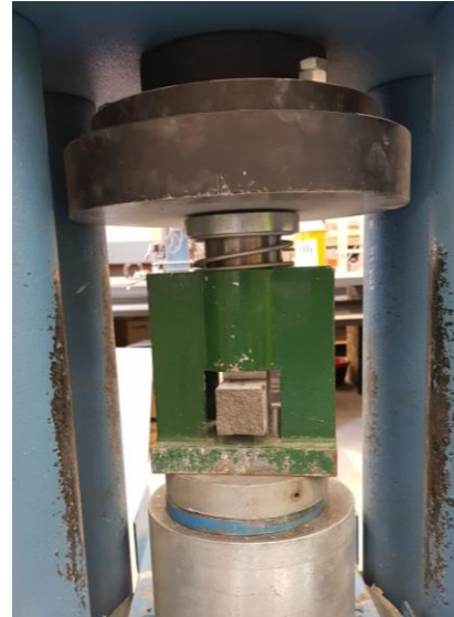
Figura 29 - Peça de auxílio no ensaio de resistência à compressão para provetes prismáticos
