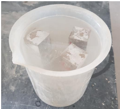
Figura 32 - Amostras imersas em água por 72 horas para ensaio de absorção por imersão
