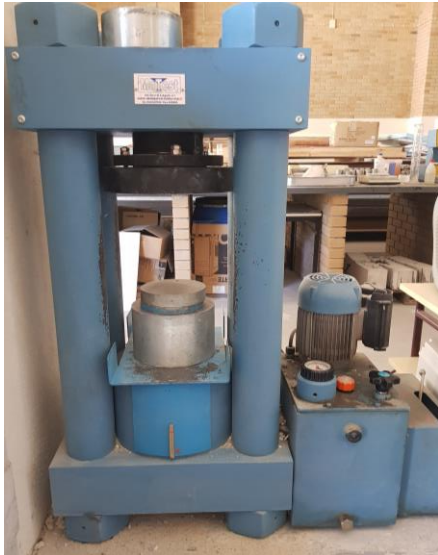
Figura 28 - Equipamento utilizado para ensaiar os provetes à compressão
