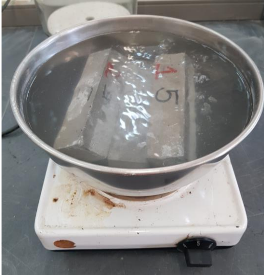
Figura 34 - Provetes em ebulição por 5 horas para o ensaio de absorção por imersão
