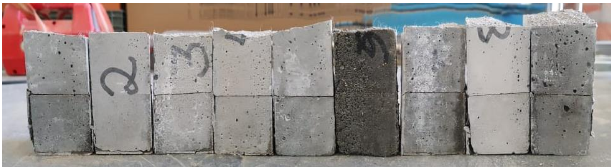
Figura 44 - Aspecto dos provetes de CPR após ensaio de resistência à compressão
