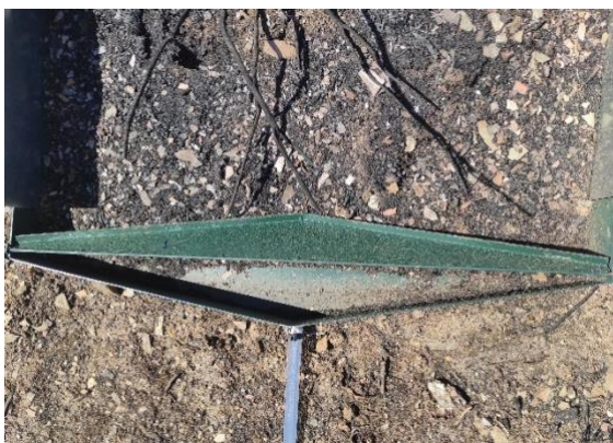
Fig. 3 – Acumulação de sedimento no dispositivo colocado na frente das parcelas de erosão
