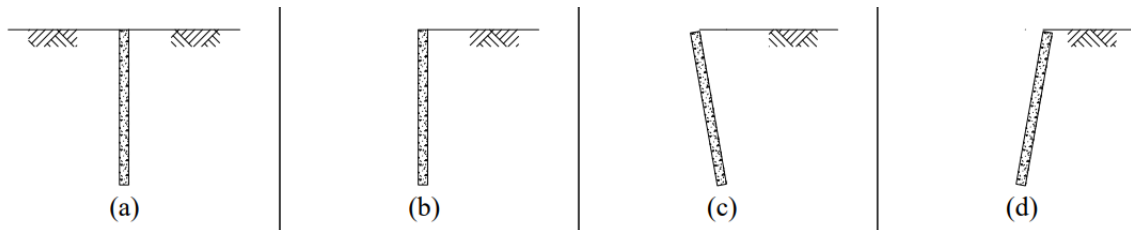
Figura 4 – Possíveis movimentações do paramento consideradas por Rankine: a) inserção do paramento no solo; b) retirada da metade esquerda do solo dividido pelo paramento; c) movimentação do paramento para longe do maciço; d) movimentação do paramento contra o maciço. Adaptado de Fernandes (2015).
