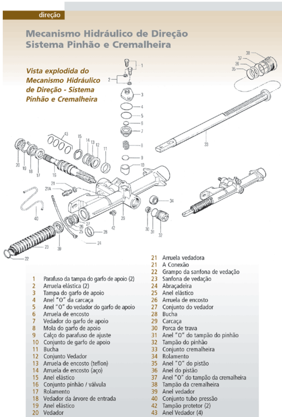
Figura 3 – Componentes de Sistema de direção hidráulica. Fonte: Revista “O MECÂNICO” (2015)
