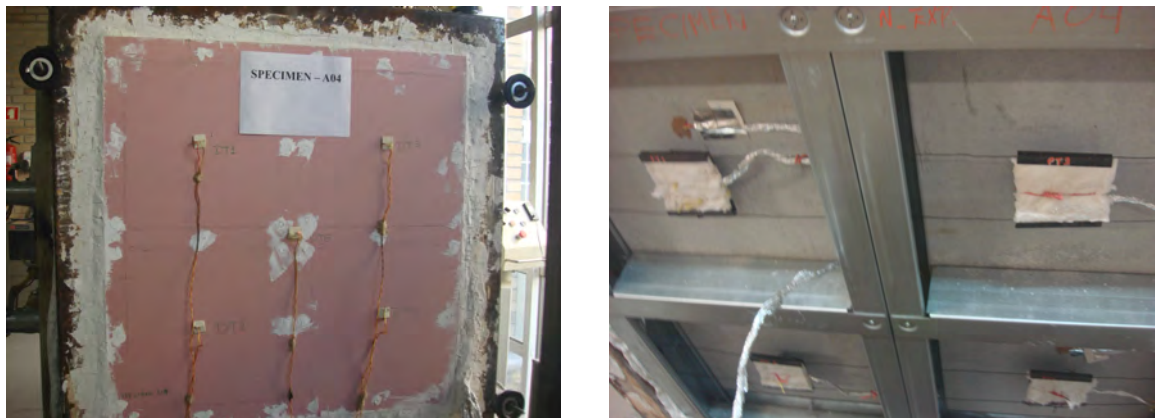
Fig. 2: Termopares de disco (DTs) e termopares de placa (PTs)
