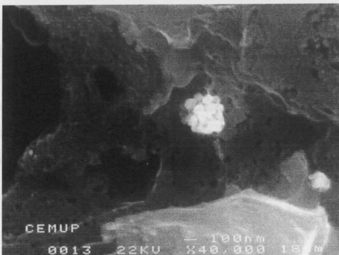
Figura 48 - Micrografia de varrimento electrónico (SEM) de um catalisador de Ni/C (4% Ni) revelando um pormenor dos aglomerados formados
