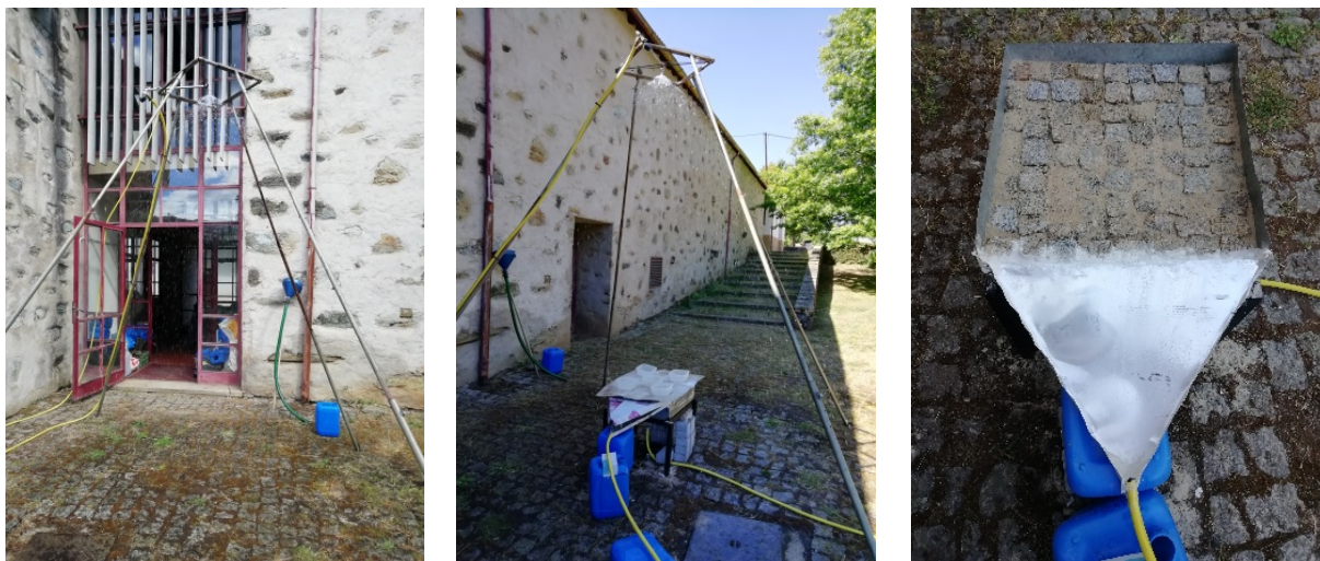
Fig. 57 - Testes de infiltração em pavimentos utilizados em áreas urbanas
