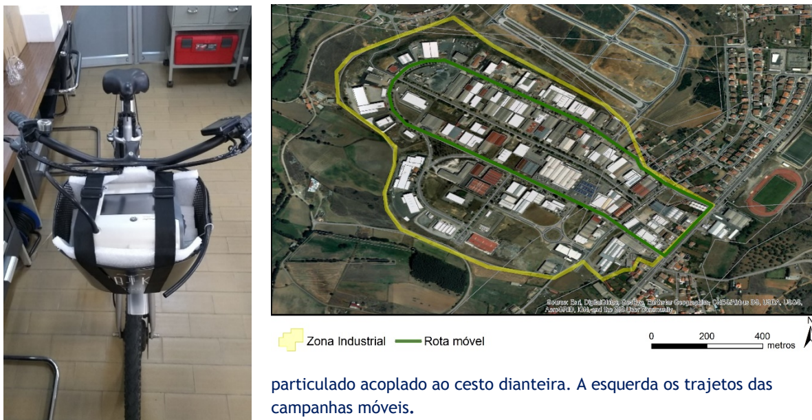
Fig. 37- Sistema de monitorização móvel. A direita encontra-se a bicicleta com o monitor de material
