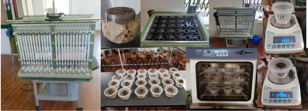
Fig. 55 - Procedimentos laboratoriais para avaliação da permeabilidade do solo
