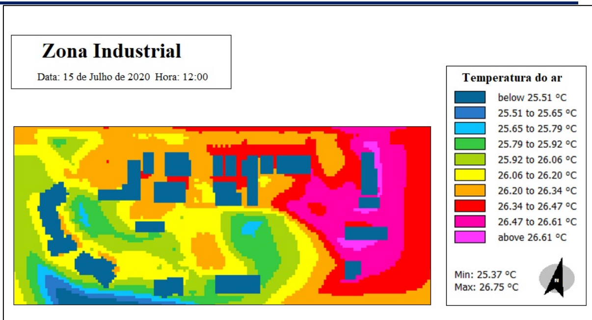
Fig. 50- Simulação da Zona Industrial através do software ENVI-Met, no dia 17 de Julho de 2020 as 12 horas.
