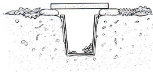
Ilustração 22 esquema de armadilhas de queda Pitfall para a amostragem. Fonte: Extreme Macro
