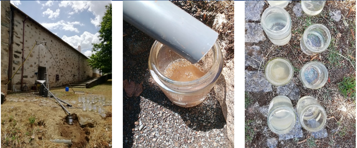
Fig. 59 - Colheita da água de infiltração e de escoamento superficial
