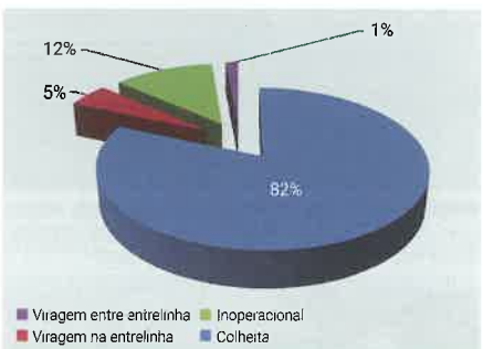
FIGURA 9. Distribuição percentual dos tempos elementares de colheita nos testes II.
