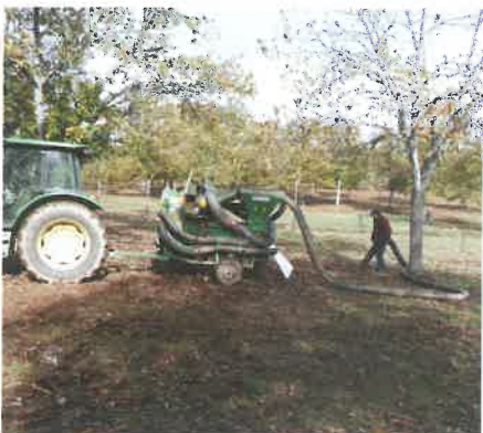
FIGURA 5. Equipamento rebocado de colheita por vácuo Monchiero 498 . As características deste equipamento indicam-se na Tabela 2.
