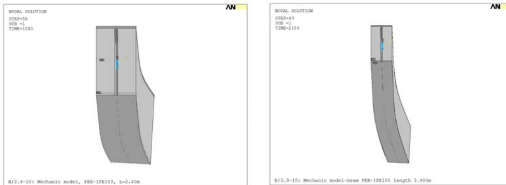
Figura 9: Deformada final del modelo numérico de VPE de longitud: (a) 2.4m y (b) 3.9m
