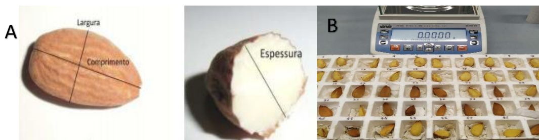
Figura 15 - (A)-Visualização dos parâmetros medidos: largura, comprimentos e espessura; (B)- Pesagem do grão.
