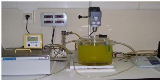
Figura 4. 2 Adsorvedor fechado com camisa de aquecimento.
