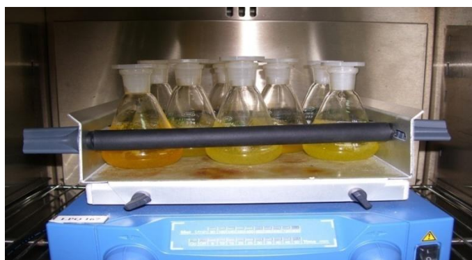
Figura 4.3 Agitador orbital com os ensaios de adsorção batch.
