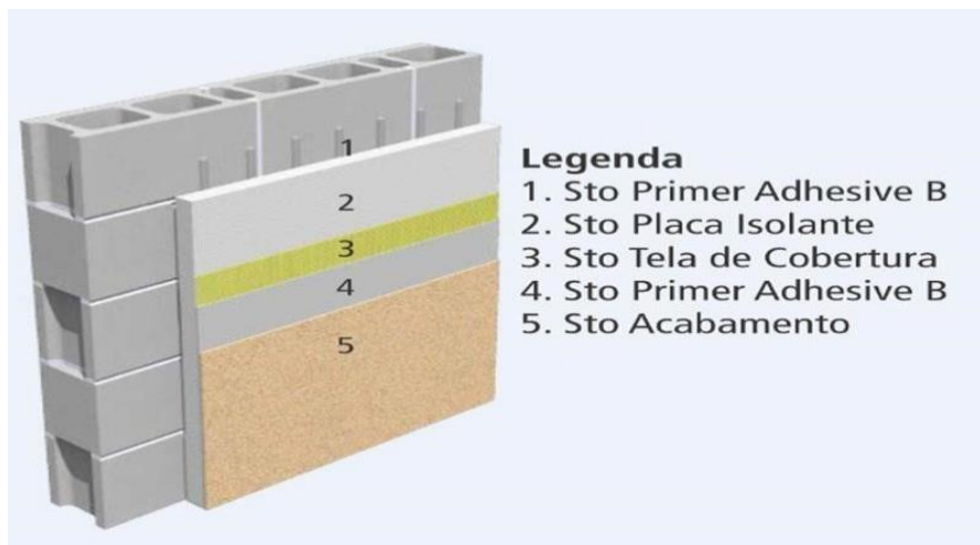
Figura 12 - Ilustração de um modelo de isolamento térmico exterior. Fonte [20]
