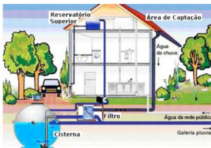
Figura 2.9 – Esquema de funcionamento de sistema de aproveitamento de água de chuva (Bella Calha, 2007).
