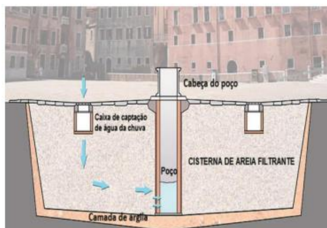
Figura 2.3 – Seção de cisterna filtrante com poço raso em uma praça de Veneza (Gnadlinger, 2015).
