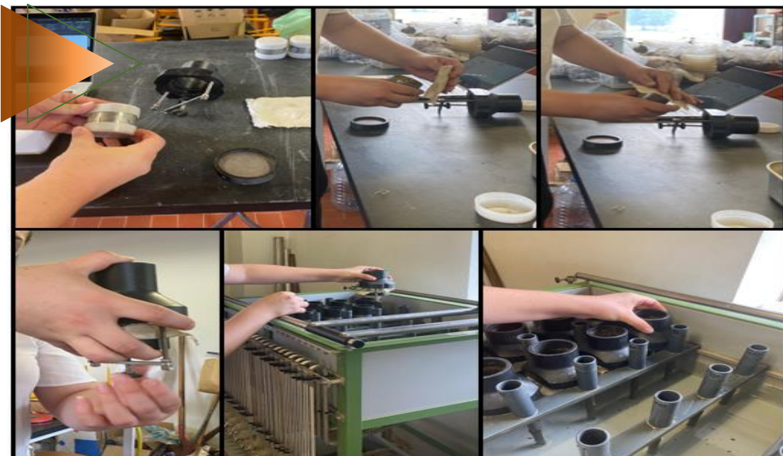
Figura 11 - Procedimentos para introdução das amostras no Permeâmetro de circuito fechado.
