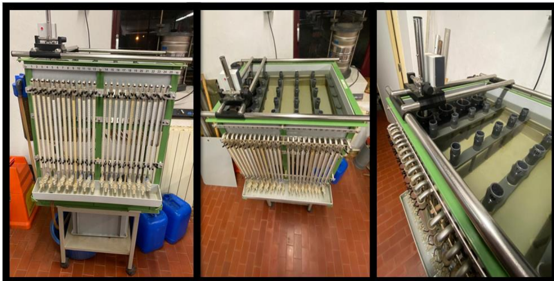
Figura 10 - Permeâmetro de circuito fechado utilizado na avaliação da permeabilidade do solo.
