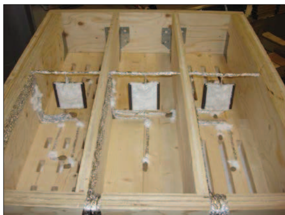
Fig. 5 – Instrumentação com termopares de fio e de placa nas três células.
