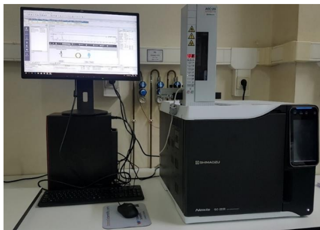
Figura 15 – Equipamento GC-FID usado para determinação do conteúdo de FAMES nas amostras.
