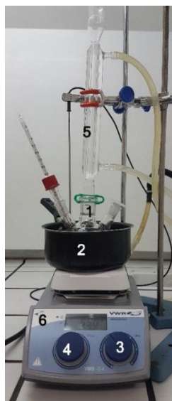
Figura 12 – Esquema reacional usado na reação de esterificação. 1-balão reacional de duas tubuladuras 2-banho com parafina 3- controlo de agitação 4-controlo de temperatura 5-condensador 6-placa de aquecimento.
