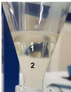
Figura 30 – Separação da mistura ácido oleico/líquido iónico 1 – ácido oleico, 2 – LI+água.
