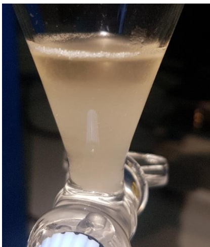
Figura 18 – Separação de fases após reação recorrendo a uma ampola de decantação.
