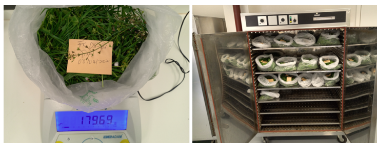
Figura 3.5: Medição da biomassa fresca da pastagem com recurso a uma balança de precisão 0,01g (à esquerda) e desidratação das amostras em estufa a 65\pm 5^{\circ}\text{C} para a determinação da matéria seca do alimento (à direita).
