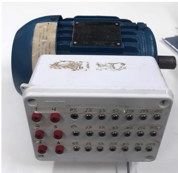
Figura 5.4 - Disposição das tomadas na caixa de ligação
